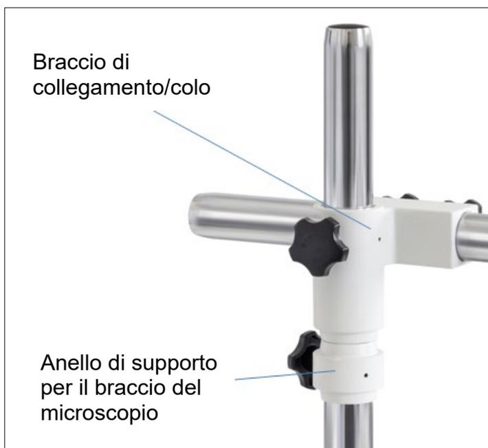
Fissare il braccio del microscopio
